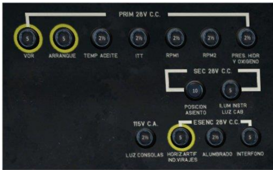
图 3-35 前舱断路器面板
