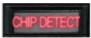
图 3-19 碎屑探测器告警灯
