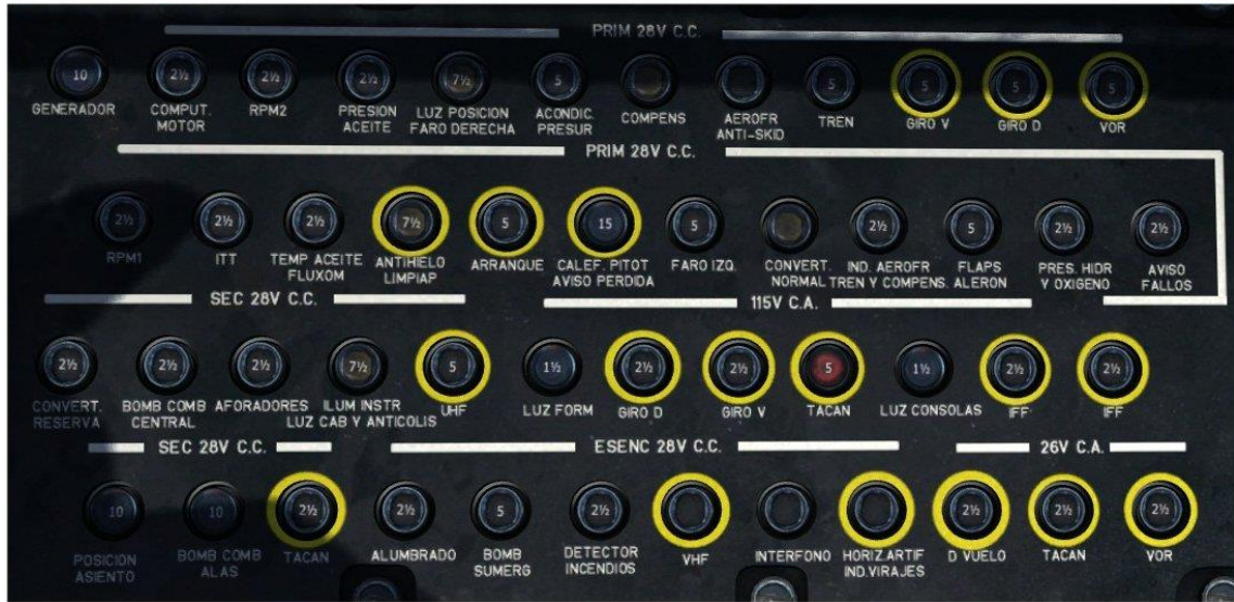
图 3-35 前舱断路器面板
